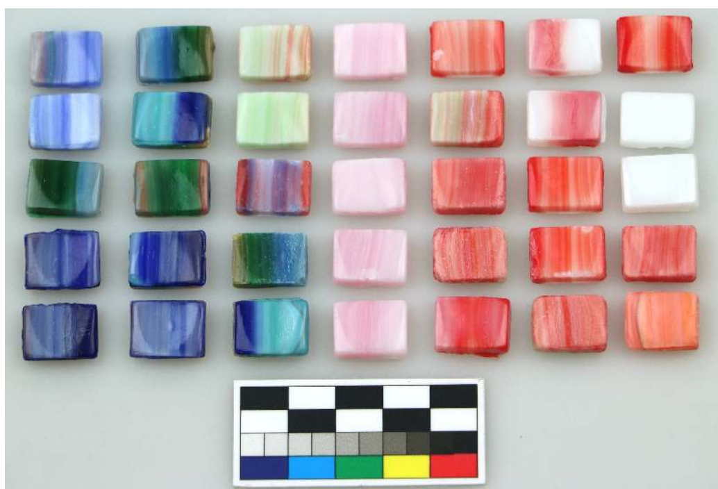
Obr. 18b Repliky rotačně mačkané mozaiky, připravené z nahodile vybraných barevných tyčí. Foto I. Kučerová
