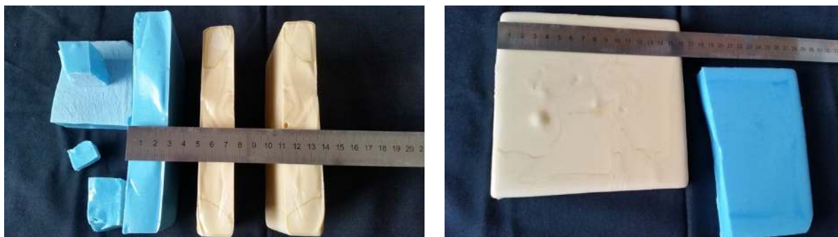
Obr. 36 Placky mozaikového skla připravené přetavením mačkárenských tyčí. Foto Jiří Blaho
