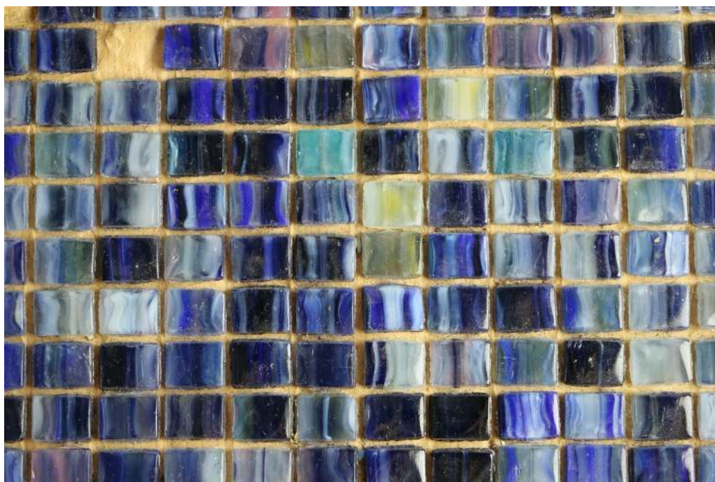
Rotačně mačkaná mozaika nalepená na papíře – detail, zásoby Františka Tesaře. Výsledná barevná skladba vznikla tzv. homogenizací, tj. promísením kostek připravených z různě barevné výchozí suroviny. Foto M. Nováková
