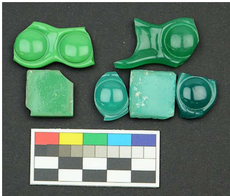
Obr. 16 Vybírání odstínu porovnáním originální kostky s vymačkanými tvary vzorníku barev mačkárenských tyčí. Foto I. Kučerová
