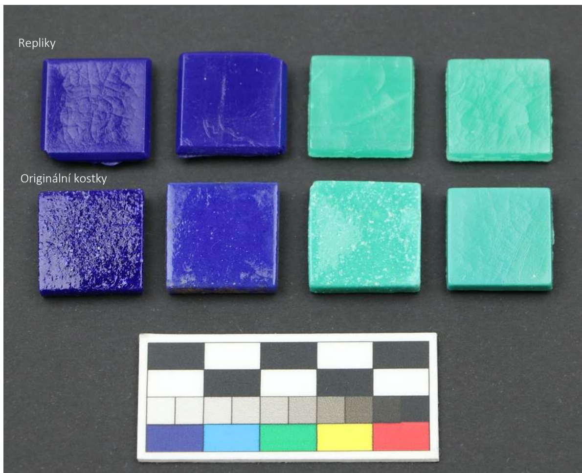
Obr. 20a Porovnání barevnosti originální sintrované mozaiky (spodní řada kostek) s vyrobenými replikami (horní řada kostek). Foto I. Kučerová
