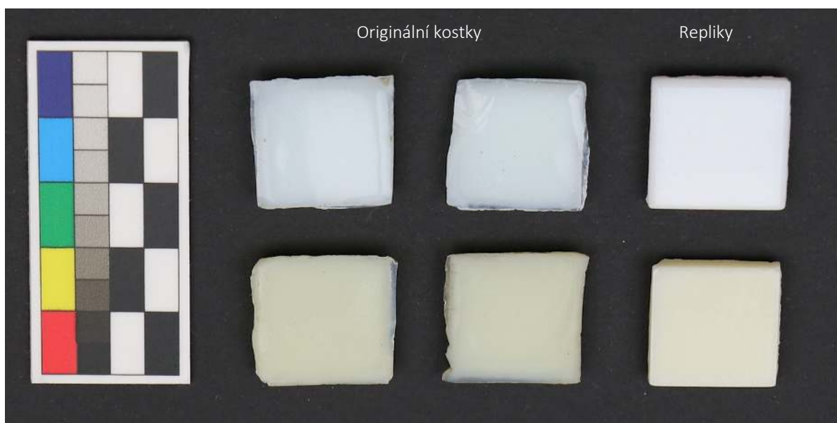
Obr. 19c Porovnání barevnosti repliky hladké lité mozaiky (kostky vpravo) s originálními kostkami (první dvě kostky vlevo). Foto I. Kučerová
